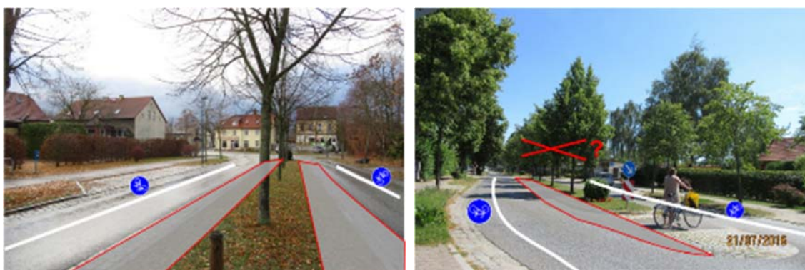
Grafik 32: Darstellung der Option einer Radverkehrsführung mit Radfahrstreifen (ungünstig)
