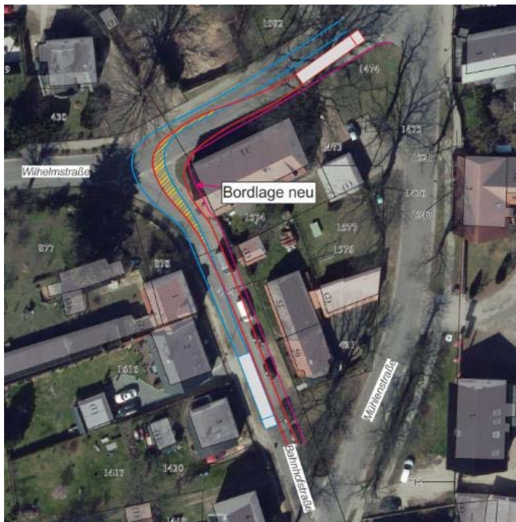
Grafik 7: Ergebnis der Schleppkurvenprüfung beim Abbiegen aus der Bahnhofstraße von/ aus Richtung Osten (Fall: Sattelzug)
