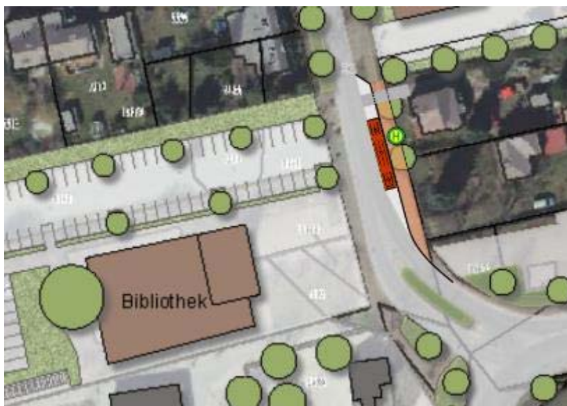
Grafik 27: Variante 2 der Verknüpfung zum S-Bahnhof durch eine Busbucht (dargestellt auf Grundlage der Planungen „Gruppe Planwerk“)
