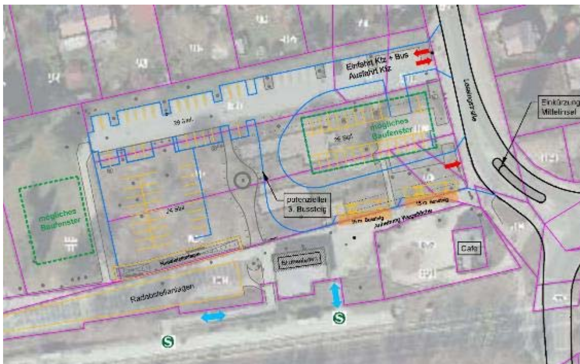
Grafik 31: Variante 1c der Einordnung von Bushaltestellen am S-Bahnhof Petershagen-Nord (Sägezahn Südseite)
